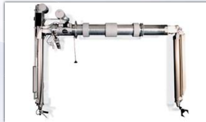
A100 マスタースレーブマニプレータ 取扱荷重：20kg（電動操作エリアを含む） 吊上力：80kg（リフティングデバイス装着時） 操作範囲：2500mm～5000mm 中規模～大規模コンクリートホットセルに適用 マスターアームの動きはスルーウォールチューブ内のシャフトの回転を通してスレーブアームに伝えられます。
