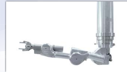
A1000 パワーマニプレータ A1000は拡張性を備えたパワーマニプレータです。特に人のアクセスが困難かつ重作業を必要とする環境、例えば、原子力関連施設、化学関連施設等で、威力を発揮します。A1000は快適な遠隔操作性、効率的な動作性、耐放性に優れており、分割可能な各アームユニットにモーターが内蔵された構造により、メンテナンス性に優れています。
