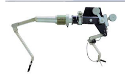
A200 マスタースレーブマニプレータ 取扱荷重：10kg（電動操作エリアを含む） 操作範囲：1500mm 中規模鉛セル、コンクリートセルに適用
