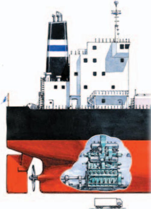
環境問題に対応した次世代エンジン1号機7S50ME-C 電子制御によりNOx、ばい煙を大幅に削減
