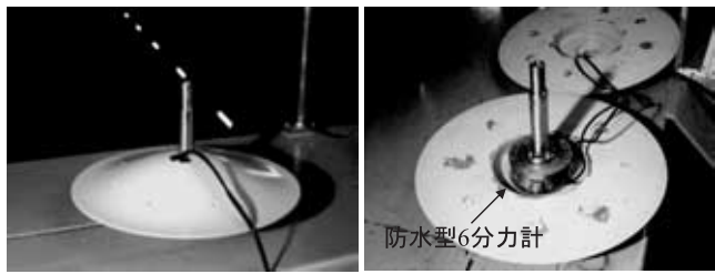
写真3 流体力計測試験用模型 400 mm Model
