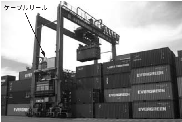
写真1 稼働中の地上給電方式トランスターナ®
