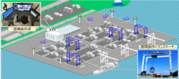
コンテナターミナルにおけるローカル 5G 通信構成図
