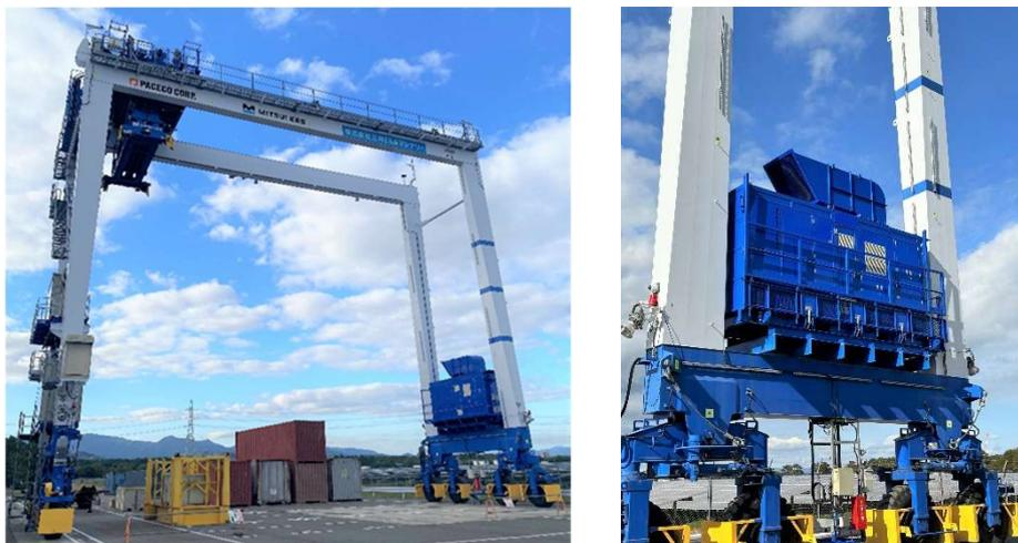
図1 今回実証試験に成功した FC パワーパック搭載の RTGC（左：全体像、右：FC パワーパック搭載部分）
