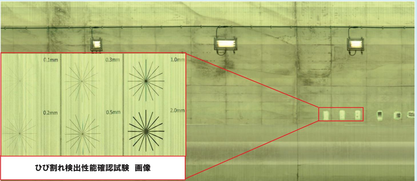
ひび割れ検出性能確認試験 画像
