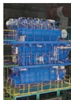
2015 DFエンジンのDU初商用機完成 5RT-flex50DF(9,790PS×124min -1 ) 中口径の低速2ストロークデュアルフルエールエンジンを 国内で初めて製造し、トルコの造船所向けに出荷。 DU's first commercial dual fuel engine is delivered to the shipyard in Turkey.
