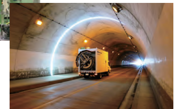
トンネル検査車両「トンネルキャッチャー3」
