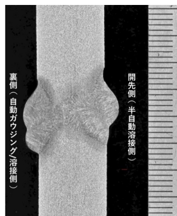
写真8 当該台車を用いて作製した突合せ継手のマクロ組 織試験結果
