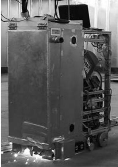
写真1 自社開発の開先做いシステムを搭載した溶接台車による溶接施工状況
