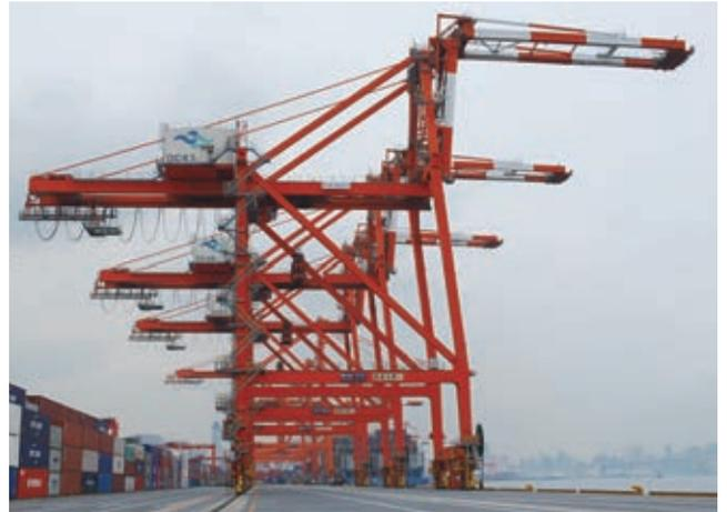
写真5 中折れ式コンテナクレーン
