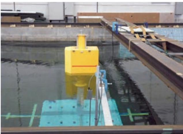
写真4 正面波による同調制御試験
