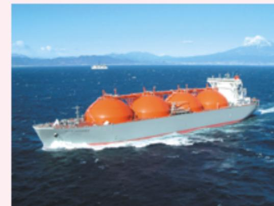
写真は140,000M<sup>3</sup>MOSS型球形タンクLNG船です。
