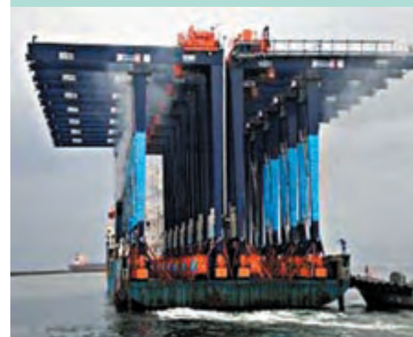
写真は脚を移動、本船に15基のトランステナーを積込んで輸送中の写真です。
