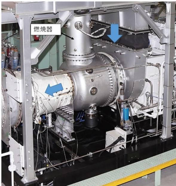
写真1 SB5Nガスタービン外観写真
