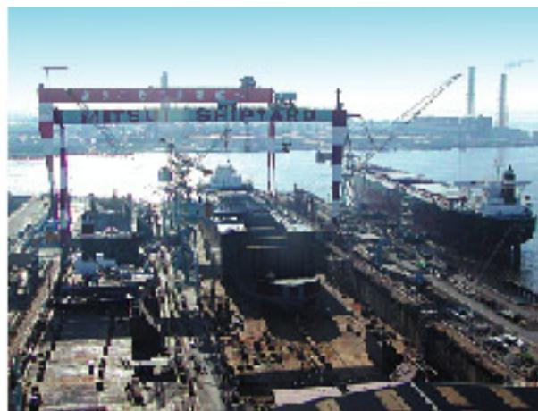
船の建造においては、鋼材からの部材切出しに際しては、無駄のないカッティングプランによる鋼材スクラップ率の減少、ブロックステージでの先行舾装率の向上、総組ステージ上での船体ブロックの大型化による作業性改善等、これまで、船種に応じて効率的に船を建造するための建造方法を確立させてきました。
