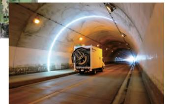
トンネル検査車両「トンネルキャッチャー3」
