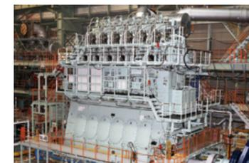
電子制御式ガスインジェクションディーゼルエンジン「ME-GI」
